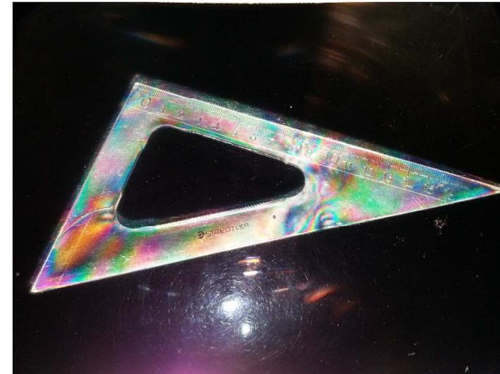
Montaje en el que se ven las bandas isocromáticas de un objeto entre dos láminas polarizadoras en un proyector de luz.
